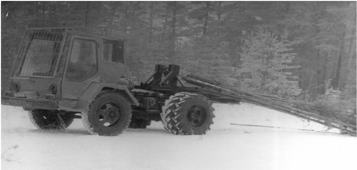
Рис. 38. Автотрактор на функциональных испытаниях в комплектации МТТ
