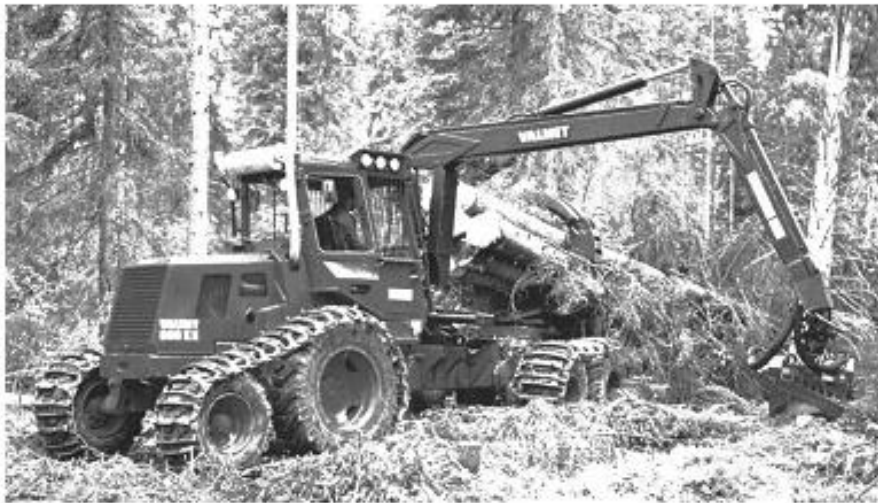
Рис. 13. Съемный гусеничный ход фирмы Валмет (Финляндия)
